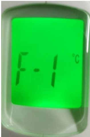
F1 Impostazione unità di misura temperatura °C o °F
