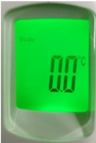
F3 Impostazione valore di calibrazione temperature da effettuarsi con l'ausilio di un termometro standard
