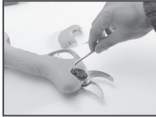
2. Retirez les vis sur la goupille de l'écrou (cette étape est critique)
