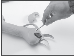
2. Smontare le viti sul perno del dado (questo passaggio è critico)
